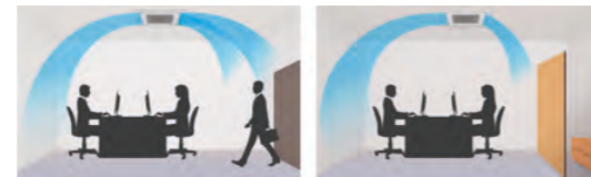
Alto nivel de confort evitando el flujo de aire frío directo sobre las personas. Climatización eficiente basada en la distribución de la sala.
