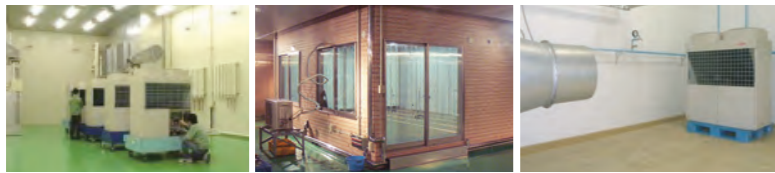
Test de condiciones ambientales severas Pruebas de inyección de agua (Estanqueidad)
