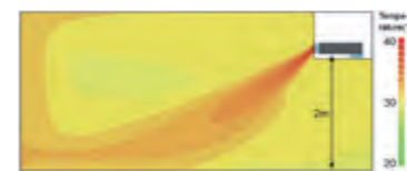
Impulsión de aire con Auto Louver.
